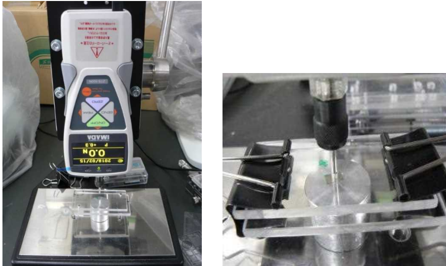
図 4.3.2-11 破断強度測定部セットアップ
