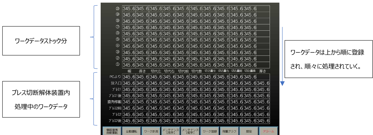
図 4.4-17 プレス切断解体装置制御盤画面
