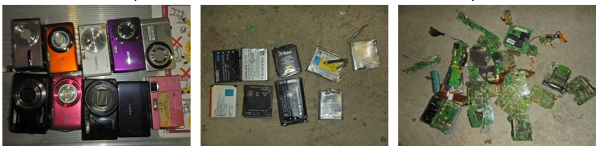
図 4.1-17 CFS 型解体機による携帯電話とデジタルカメラ破碎実験結果の例
