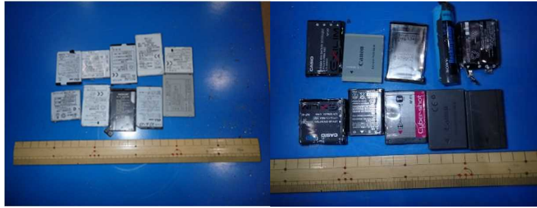
図 4.4-14 CFS 型解体機による一次解体で取り出した電池の例 写真左) 携帯電話から取り出した電池の例(投入台数 10 台から電池 10 個) 写真右) デジタルカメラから取り出した電池の例(10 台から電池 10 個)
