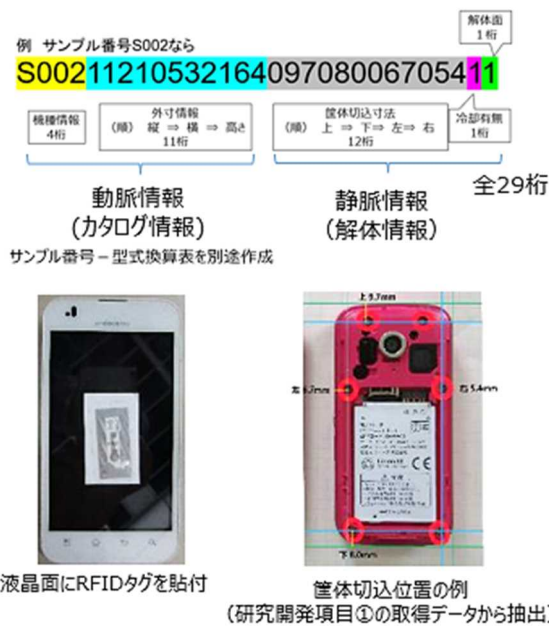
図 4.4-19 Passive 型 RFID タグに記録した解体コードと試験用スマホサンプルの例
