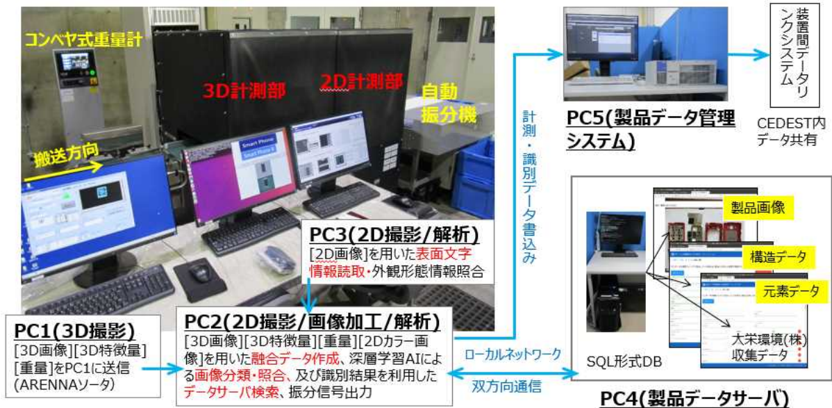
図 4.1-2 製品ソータ試験モジュールの構成
