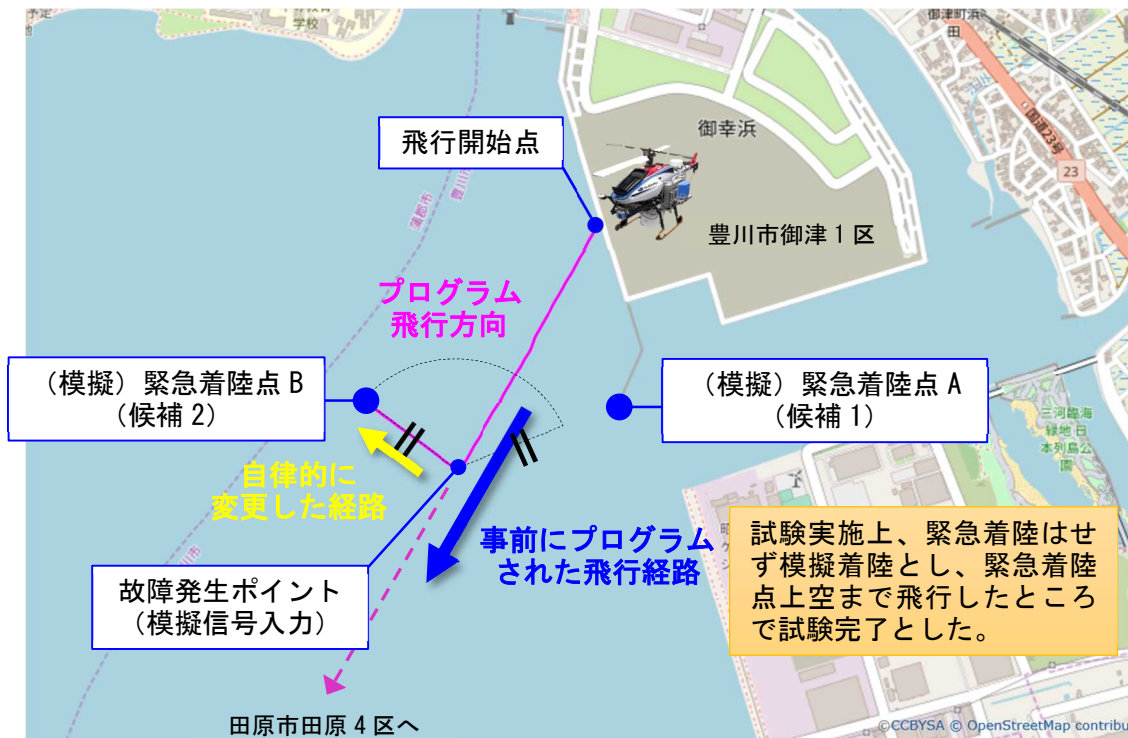
図 2.2.1.5-21 故障時経路変更機能確認試験の試験結果概要
