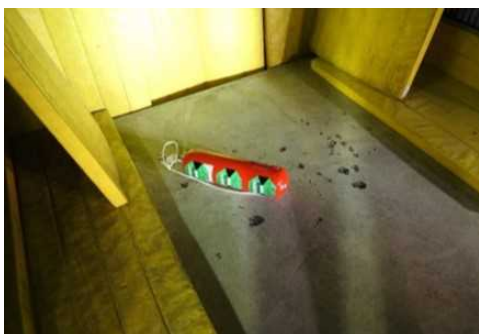
図 2. 1. 1. 7-234 水平落下試験後写真 1 （全体）
