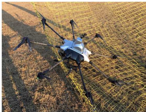
図 2. 1. 1. 7-392 水平飛行からの落下試験で、受止装置で受け止められたが、ネット上の落下位置が低すぎたため、地面に衝突して破損した X-F1
