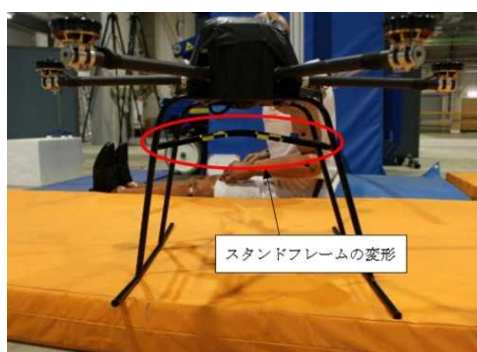
図 2. 1. 1. 7-79 垂直落下実験後の無人航空機 7. 6kg の状態
