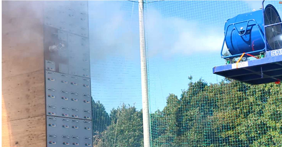
図 2. 1. 1. 2-114 発煙筒による人工流の見える化例
