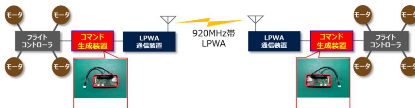
図 2. 2. 1. 9-59 コマンド生成装置を介した LPWA 通信装置と フライトコントローラの接続
