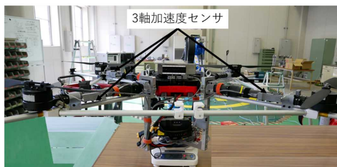
図 1-4-3-d-1.2 加速度センサの設置位置
