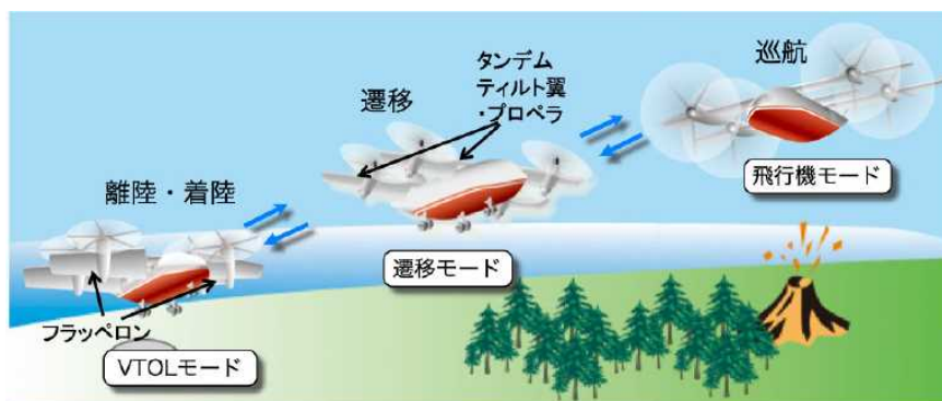
図 1-5-1-a. 3 QTW 無人航空機の飛行形態
