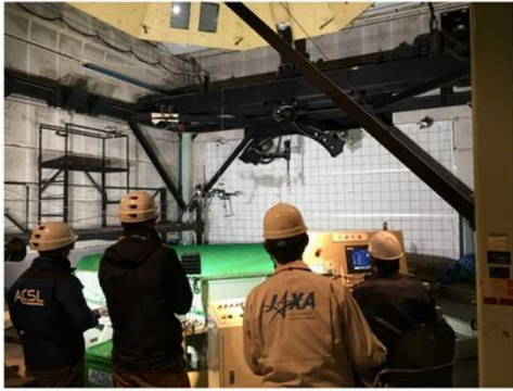
図 2.1.1.7-157 ボルテックスリング 現象観測試験の様子 (PF-1)
