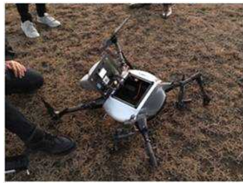
図 2.1.1.8-218 水平飛行からの落下試験で受止装置外に落下して破損した X-S1
