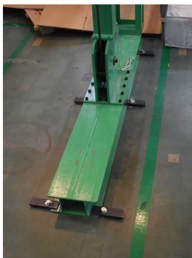
図 2. 1. 1. 7-55 アンカー止めされた投頭機台座部
