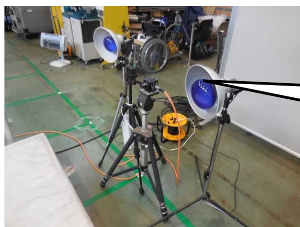
図 2. 1. 1. 7-54 高速度カメラ及び照明装置
