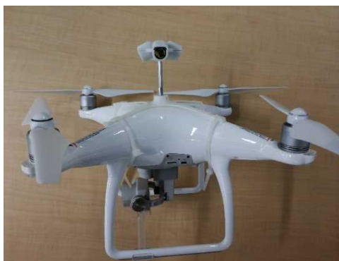
図 2.1.1.2-20 小型プリズム設置 （全方位）1
