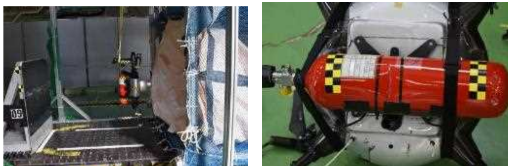
図 1-4-6.5.6-1 小型ドローン（底面）衝撃試験前と後の写真
