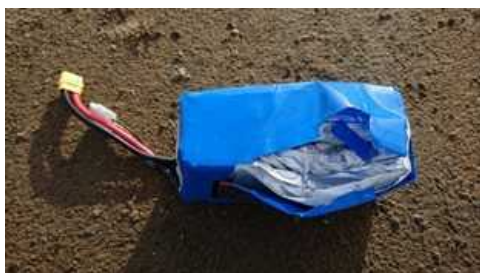
図 2. 1. 1. 7-42 落下試験により発生したバッテリーの圧損(機体が軽量化されたボディは、落下により比較的容易に変形し、内部のバッテリーにもダメージを与える。)
