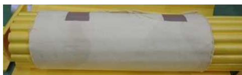
図 2. 1. 1. 7-288 18m/s 水平衝撃試験後 写真 3（保護付容器①）
