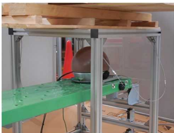
図 2. 1. 1. 7-53 投頭機に設置されたヘッドインパクター
