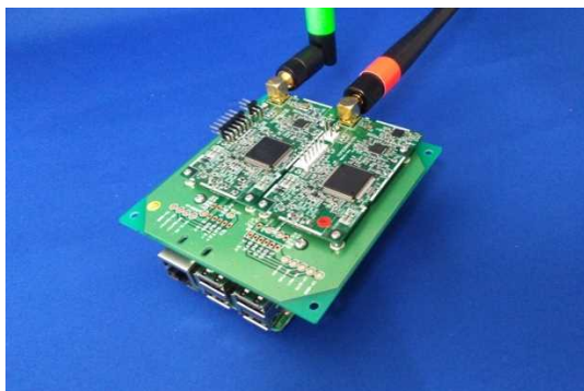
RF モジュールを接続した様子
