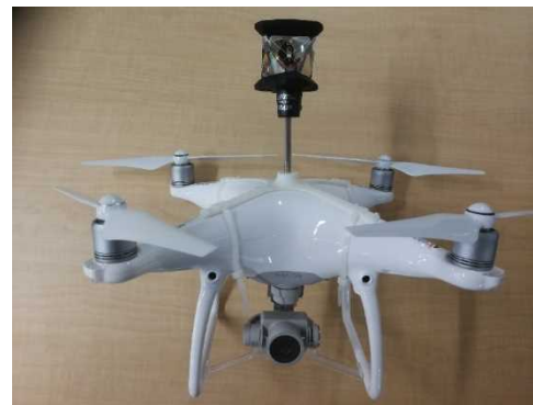
図 2.1.1.2-17 ATP2S 設置(小型機)
