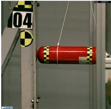
図 2. 1. 1. 7-252 7. 7m/s 垂直衝撃試験高度カメラ写真（最大変形時）
