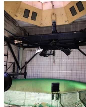
図 2.1.1.7-160 落下終端速度・ 姿勢観測試験 (Phantom3 背面プロペラ無し)
