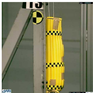
図 2. 1. 1. 7-295 18m/s 水平衝撃試験 高度カメラ写真 （保護付容器①、最大変形時）
