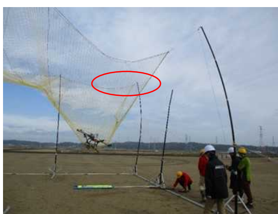
図 2. 1. 1. 7-32 PRODRONE X-F1 落下試験
