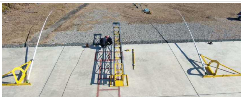
図 1-5-2-1-b-1.1 2020 年度開発 固定翼機発射装置
