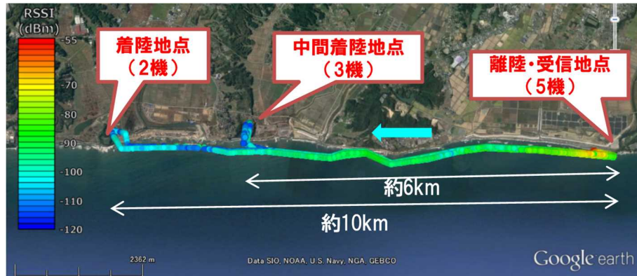
図 2. 2. 1. 3-28 5 機同時長距離飛行において離陸・受信地点に設置した地上モニタ局の移動体端末間通信モジュールで受信された移動軌跡と各ドローンからの受信電力
