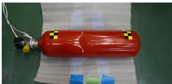
図 1-4-6-a-3.1 水素容器 衝撃試験後（容器①）
