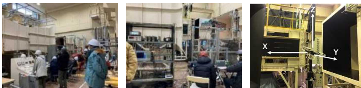
図 1-5-5-6 ドローンの速度限界計測風洞試験
