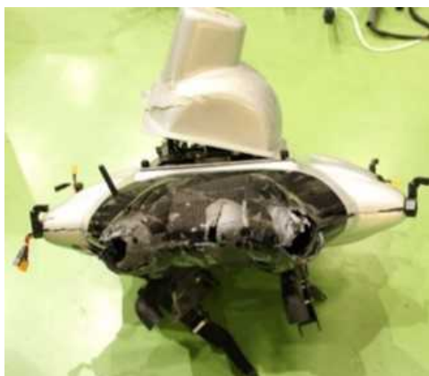
図 2.1.1.7-333 18m/s 衝撃試験後 写真 1（ドローン②）
