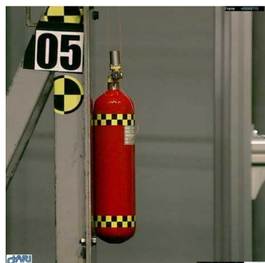
図 2. 1. 1. 7-256 7. 7m/s 水平衝撃試験 高度カメラ写真（最大変形時）
