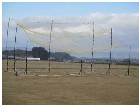
図 2. 1. 1. 7-26 斜めにネットを張ったドローン受け止め回収装置
