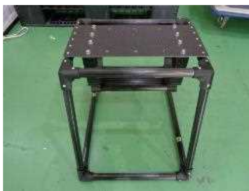
図 1-8-2.15 カーボンボックスフレーム例
