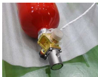
図 2. 1. 1. 7-276 18m/s 垂直（バルブ） 衝撃試験後写真
