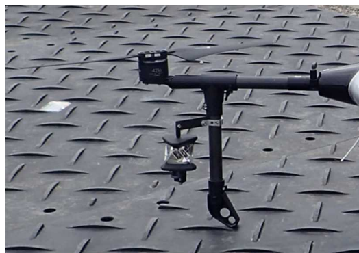
図 2.1.1.2-19 ATP2S 設置〈大型機〉2
