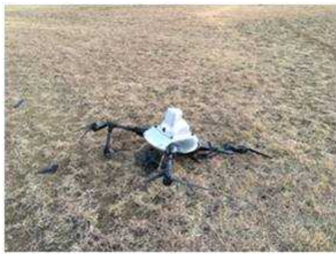
図 2.1.1.8-218 水平飛行からの落下試験で受止装置外に落下して破損した X-S1
