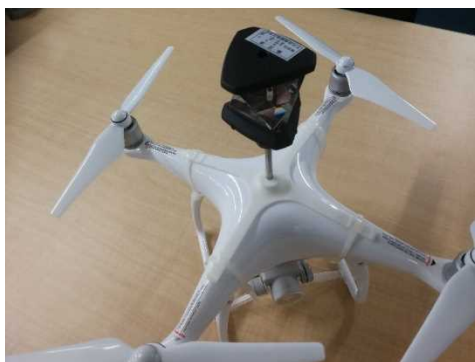
図 2.1.1.2-16 ATP2S 設置(小型機)1
