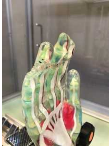
図 2.1.1.7-120 手指ダミーの損傷（検証試験結果）
