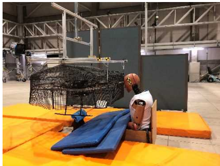
図 2.1.1.7-82 ガード付き 無人航空機の設置状況
