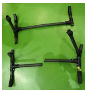
図 2.1.1.7-320 18m/s 衝撃試験後 写真 2（ドローン①）
