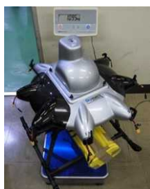
図 2.1.1.7-317 試験前重量 測定（ドローン①）
