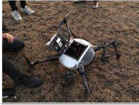
図 2. 1. 1. 7-391 水平飛行からの落下試験で受止装置外に落下して破損した X-S1
