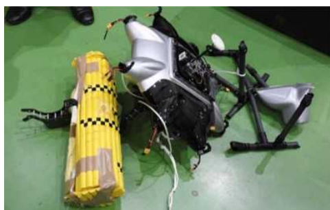
図 2.1.1.7-319 18m/s 衝撃試験後 写真 1（ドローン①）
