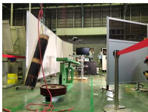
図 2.1.1.7-51 重り落下直後、ヘッドインパクターが無人機に下から衝突し、無人機も飛び上がっている様子
