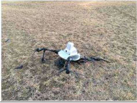
図 2. 1. 1. 7-391 水平飛行からの落下試験で受止装置外に落下して破損した X-S1
