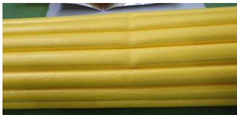
図 2.1.1.7-300 18m/s アングル衝撃 試験後写真 4 (保護付容器①)
