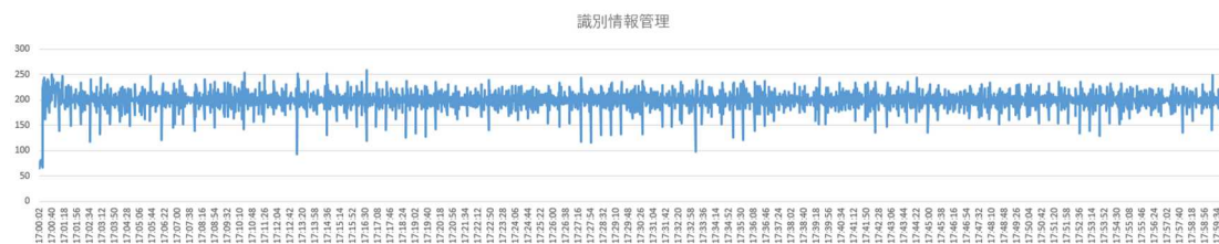
図 2.2.1.9-9 性能改善環境での負荷試験時処理件数（識別情報管理）
