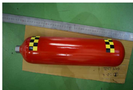
図 1-4-6-a-3.2 保護付き水素容器衝撃試験後（保護材①）
