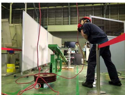
図 2.1.1.7-50 重りを落下させる様子
