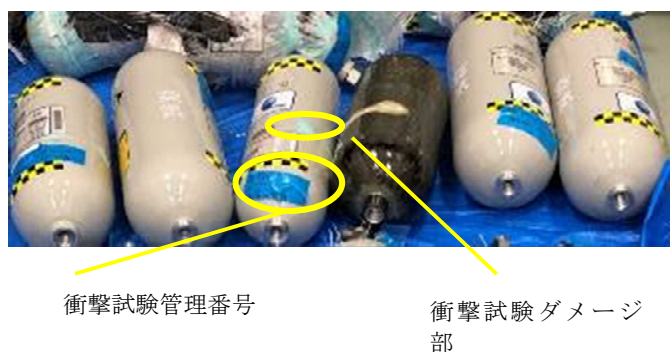
図 1-8-3.13 衝撃試験後の水素燃料容器の例
