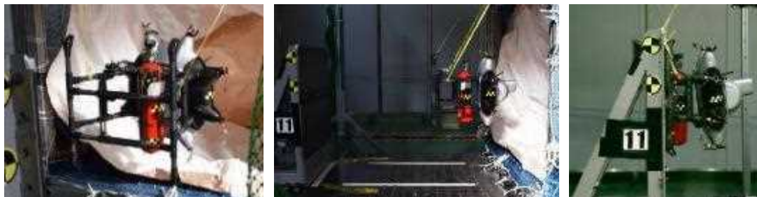
図 1-4-6.5.8-1 中型ドローン（底面）衝撃試験前後写真
