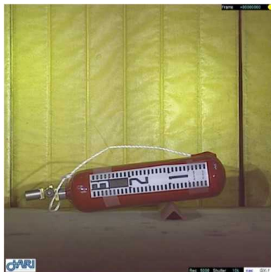
図 2.1.1.7-244 アングル落下試験 高度カメラ写真 1（アングル接触時）
