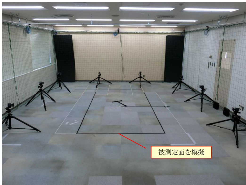
図 2.1.1.2-65 モーションキャプチャのカメラ配置
