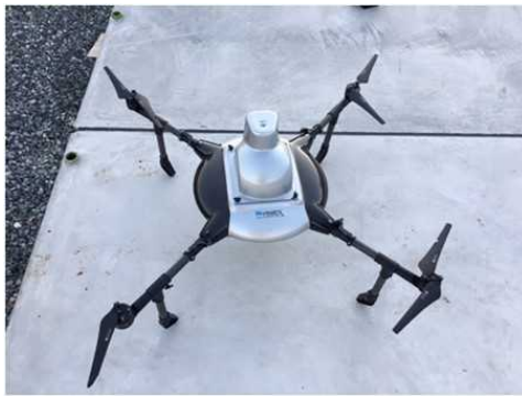
図 2.1.1.7-214 垂直落下試験で プロペラが破損した X-S1
