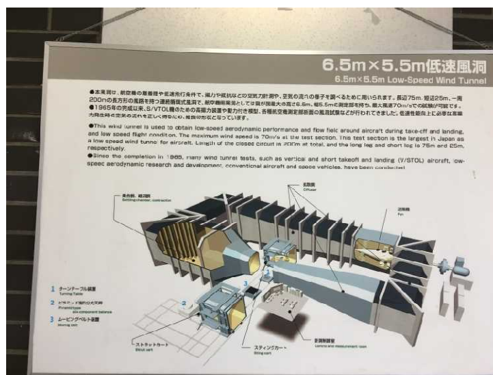
図 2.1.1.6-5 JAXA 大型風洞（低速風洞）
