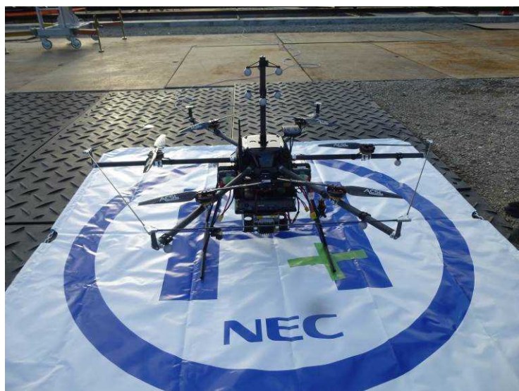
図 2.1.1.2-71 中型機 (ACSL-PF1) への模擬打検棒の設置
