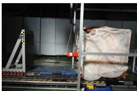
図 2. 1. 1. 7-275 18m/s 垂直（バルブ） 衝撃試験前写真
