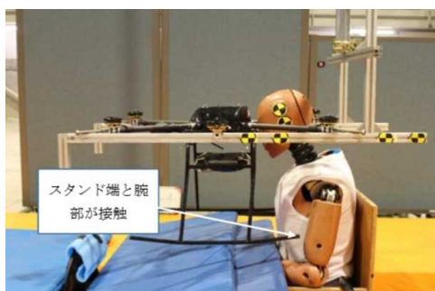
図 2.1.1. 7-105 PF-1 ガードなしの衝突の状況
