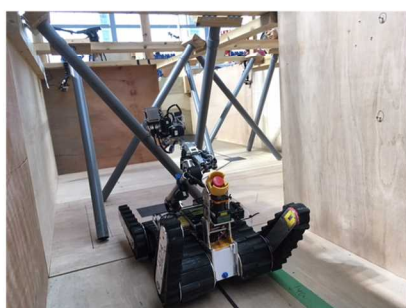
図 2.1.1.5-7 狭隘部の通過性を検証する基本性能評価手法“ジャングルジム”概要
