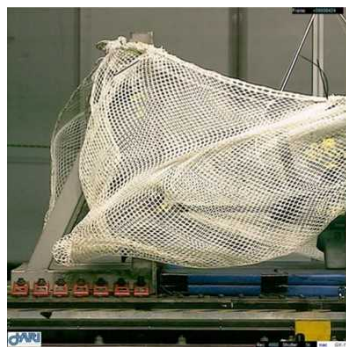
図 2.1.1.7-338 18m/s 垂直衝撃試験 高度カメラ写真 (アーム接触時)
