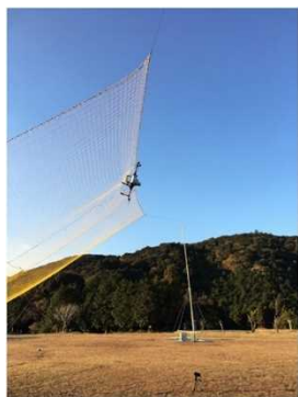
図 2.1.1.7-219 水平飛行からの落下 試験で受止装置ぎりぎりのライン で落下した X-S1
