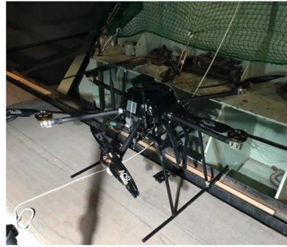
図 2.1.1.7-158 ボルテックスリング 現象観測試験用供試体 (PF-1)
