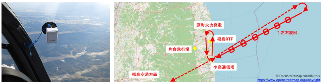
図 2. 2. 1. 9-73 実験用ヘリコプタに搭載したポータブル ADS-B 装置（左） 評価飛行パターン（福島 RTF 周辺）
