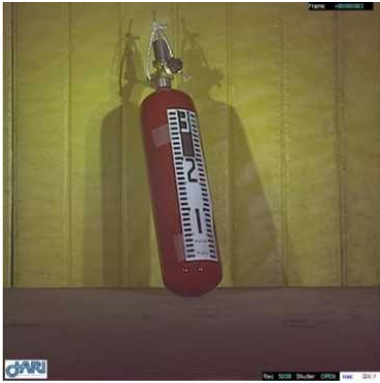
図 2.1.1.7-231 垂直落下試験高度 カメラ写真 2（最大変形時）
