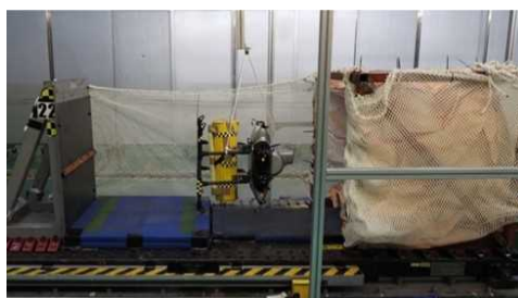
図 2.1.1.7-318 18m/s 衝撃試験前 前写真（ドローン①）
