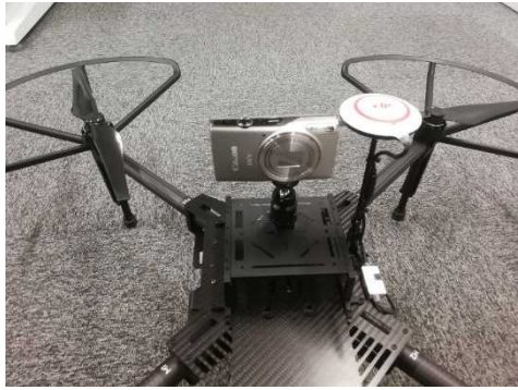
図 2.1.1.2-14 カメラ水平方向設置
