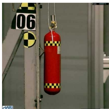
図 2.1.1.7-260 7.7m/s アングル衝撃試験 高度カメラ写真 1（最大変形時）
