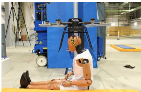
図 2.1.1.7-74 無人航空機の設置状況
