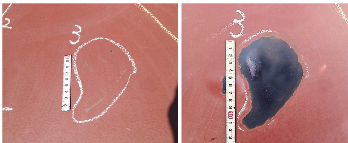
図 2.1.1.1-22 塗装を剥離する前の損傷状況と塗装剥離後の母材損傷状況
