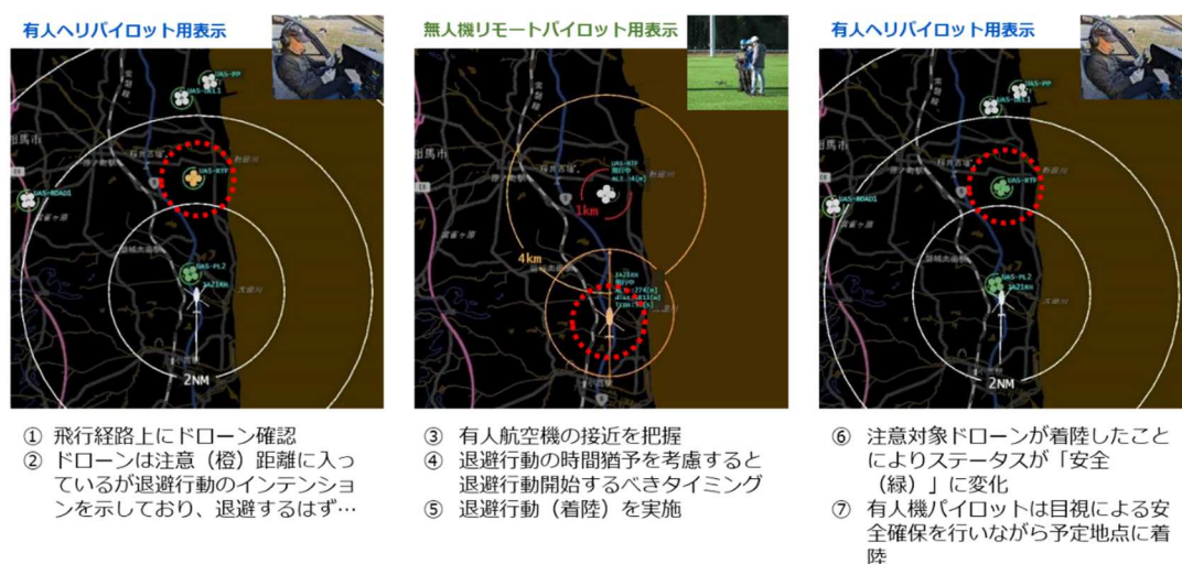
図 2.2.1.9-80 無人航空機パイロットへの有人機接近情報提供と、ヘリパイロットへのドローン位置情報提供（ドローンが有人航空機の Well Clear（パイロットが十分に安全であると見做せる安全距離）を維持して退避行動をとったケース模擬）
