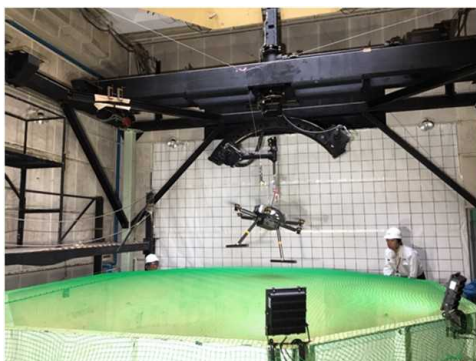
図 2.1.1.7-155 落下終端速度・ 姿勢観測試験 (PF-2 水平プロペラフリー)
