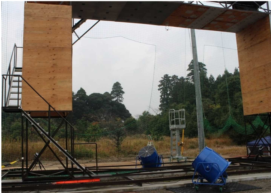
図 2. 1. 1. 2-115 送風機 2 台での人工流設定例
