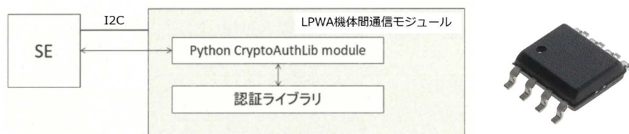
図 2. 2. 1. 9-65 認証システムの構成と採用したセキュリティエレメント（SE） （MicrochipTechnology 社製 ATSHA204A）
