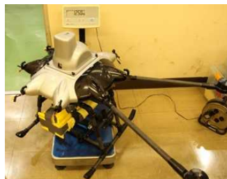
図 2.1.1.7-330 試験前重量測定（ドローン②）
