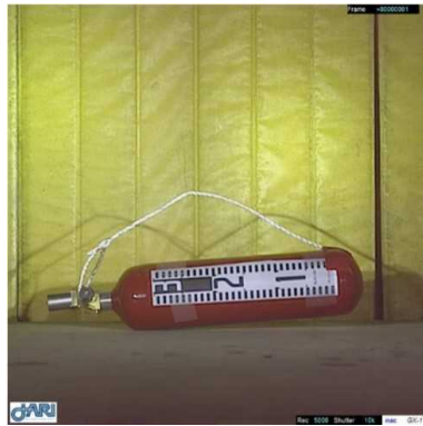
図 2.1.1.7-238 水平落下試験高度 カメラ写真 2（最大変形時）
