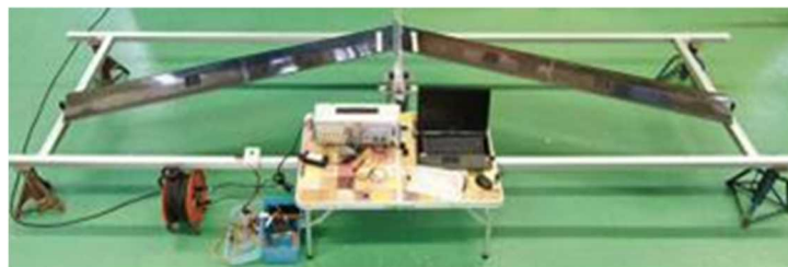
図 1-5-3-b. 1 カーボン主翼の耐空強度試験
