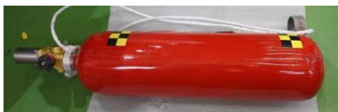
図 2. 1. 1. 7-268 18m/s 水平衝撃試験後 写真 1 (容器①)
