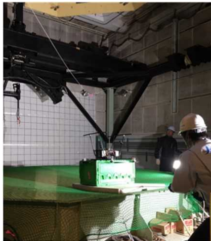
図 2.1.1.7-152 落下終端速度・ 姿勢観測試験 (PF-1 背面プロペラフリー)
