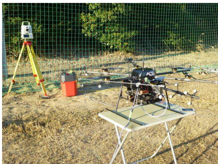
図 2.1.1.2-84 中型機（ACSL-PF1）への模擬打検棒の設置
