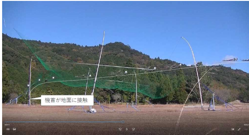
図 1-5-2-1-d-3-2.5 受け止めの様子
