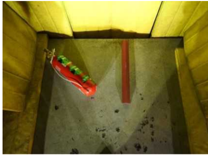
図 2.1.1.7-241 アングル落下試験後 写真 1（全体）
