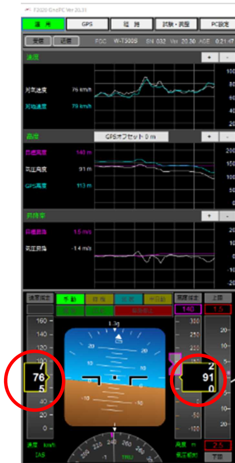
図 1-5-4-5 飛行試験時の計器画面の速度表示（左）と高度表示（右）
