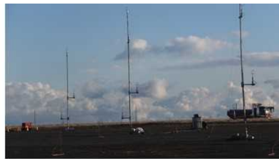
3次元風速計設置状況
