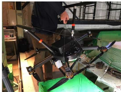
図 2.1.1.7-154 落下終端速度・ 姿勢観測試験供試体準備 (PF-2 背面プロペラフリー)
