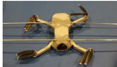
図 2.1.1. 7-98 治具を取り付けた 200g ドローン例 2
