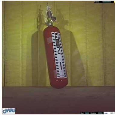
図 2.1.1.7-230 垂直落下試験 高度 カメラ写真 1（コンクリート接触時）
