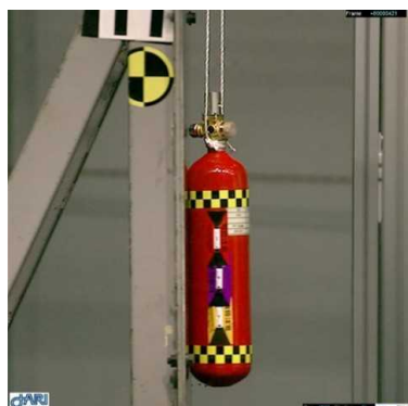
図 2.1.1.7-2780 18m/s 水平衝撃試験高度カメラ写真（容器①、最大変形時）
