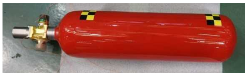
図 2. 1. 1. 7-255 7. 7m/s 水平衝撃試験後写真 2（衝撃部位）
