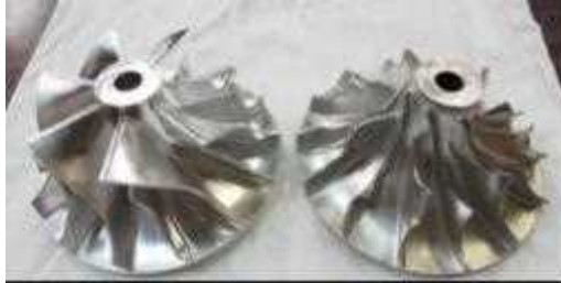
図 1-4-4-d-1.3 ジェットエンジンのタービンブレードの損傷の様子（左；試験前、右；試験後）
