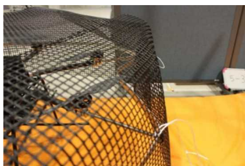
図 2.1.1. 7-103 衝突により変形した PF-1 のガード
