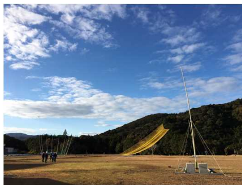
図 2.1.1.7-217 水平飛行からの落下 試験用受止装置（横から見た図）
