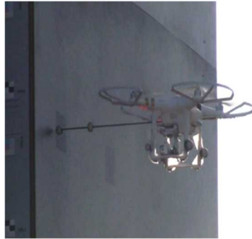
図 2.1.1.2-85 小型機 (Phantom3) への模擬打検棒の設置
