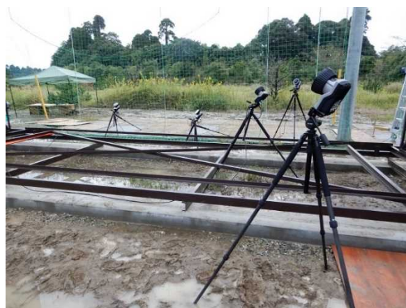
図 2. 1. 1. 2-94 3D モーションキャプチャの配置
