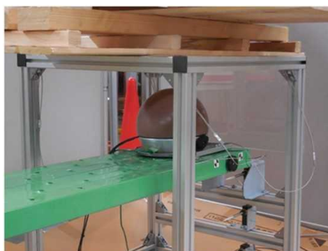
図 2.1.1.7-72 ヘッドインパクトの設置状況
