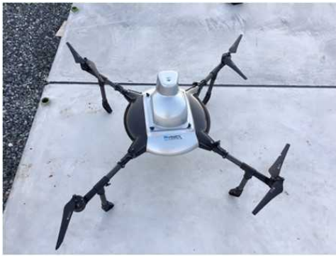
図 2. 1. 1. 7-387 試験でプロペラが 破損した X-S1
