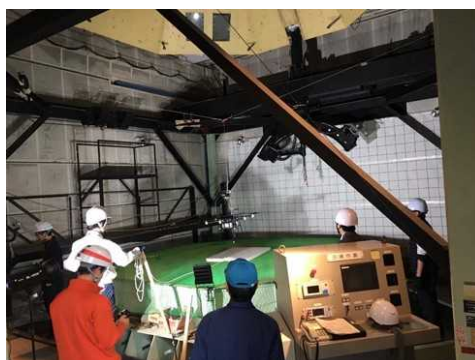
図 2.1.1.7-379 垂直風洞を用いた落下終端速度の計測の様子
