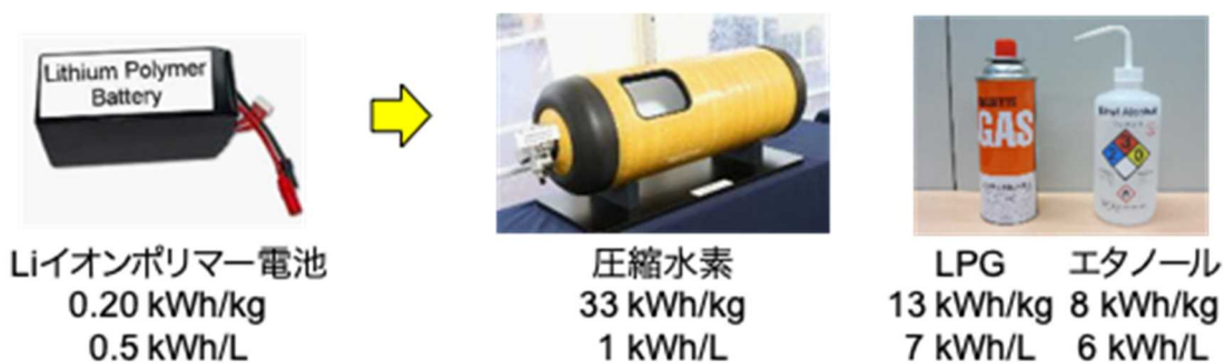
図 2.1.2.2-3 二次電池・燃料のエネルギー密度
