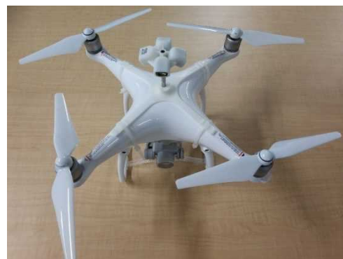
図 2.1.1.2-21 小型プリズム設置 （全方位）2
