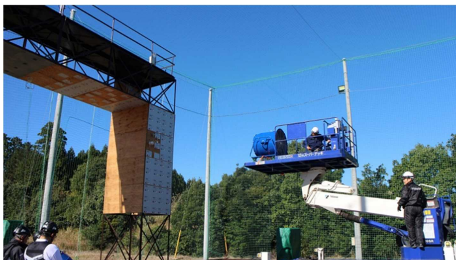
図 2.1.1.2-113 送風機1台での人工流設定例
