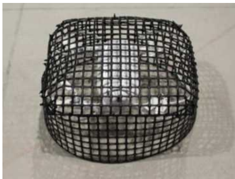
図 2.1.1. 7-92 ガード付きの 無人航空機 (200g ドローン例 1)
