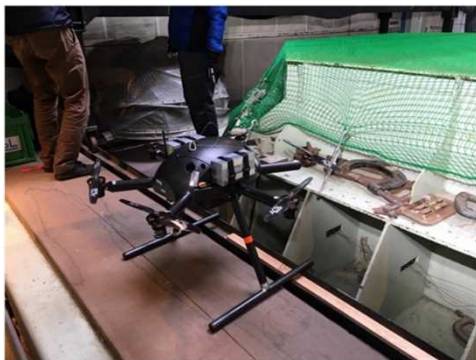
図 2.1.1.7-153 落下終端速度・ 姿勢観測試験供試体準備 (PF-2 水平プロペラフリー)
