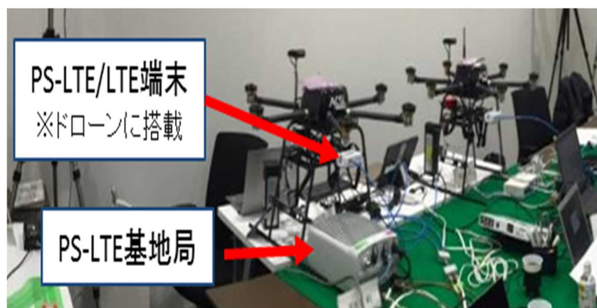
図 2. 2. 1. 1-12 PS-LTE/LTE マルチ接続通信環境
