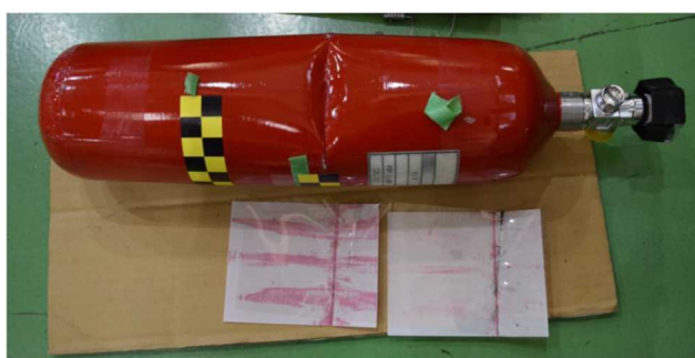
図 1-4-6-a-3.7 カーボンフレーム①衝撃試験
