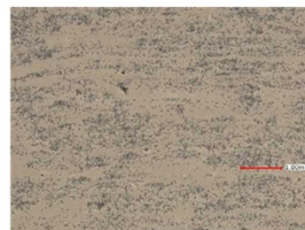
界面コーティング繊維を用いたAC成形品の断面
