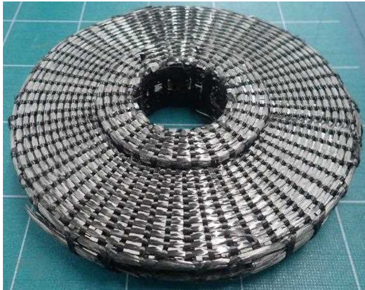
図7 ニアネットシェイプでの三次元プリフォーム製法技術を応用して製作した ブレーキディスク形状模擬品
