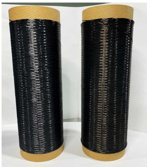
図3. 本研究開発で試作した超高性能 SiC 繊維(右側)
