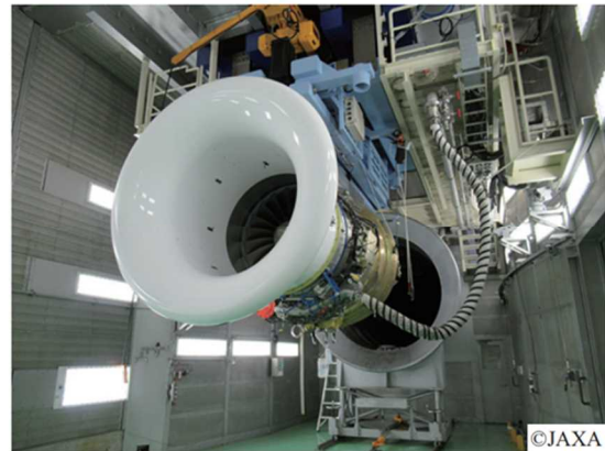
図 1 1400℃級 CMC タービンシュラウドとエンジン試験に供試した JAXA F7 エンジン
