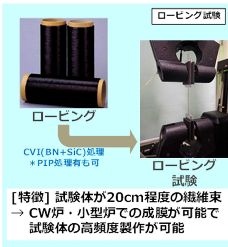
図④-(1)-1 ロービング試験概要と試験の様子
