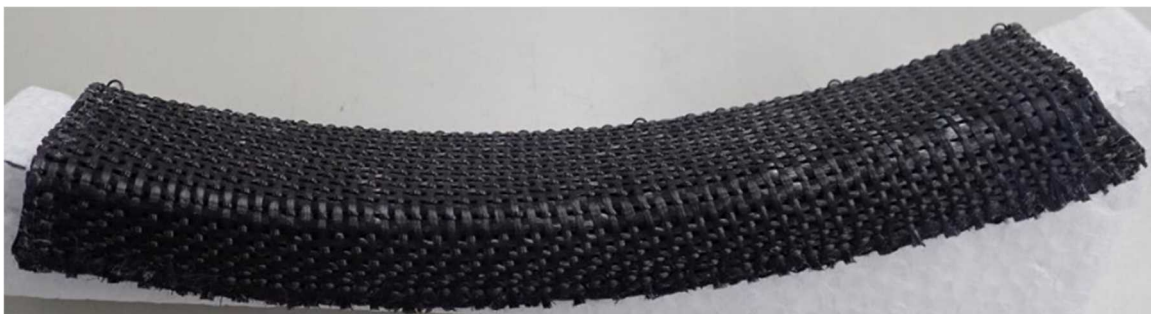
図 4-2 目標形状を模擬したニアネットシェイプでの SiC 繊維三次元プリフォーム試作品
