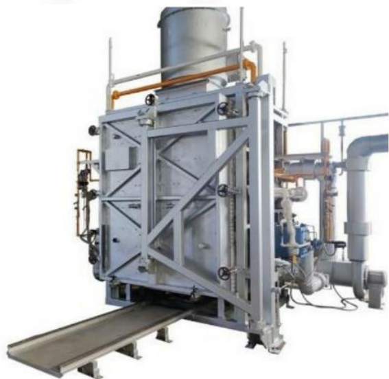
省エネルギー型熱処理・工業炉 (プロトタイプ、有効容積 1.3m 3 )
