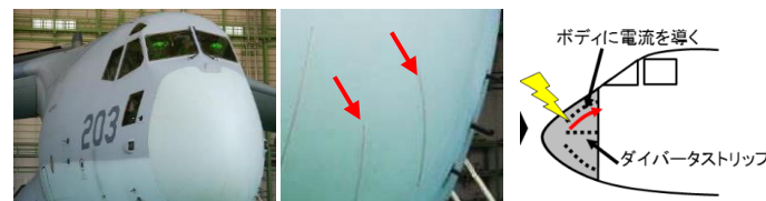
図1 航空機のダイバーストリップ
