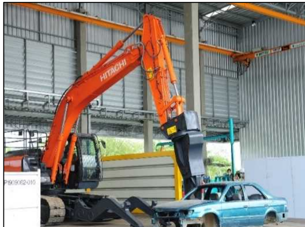
図 9 ELV 事業導入技術（解体用重機）
