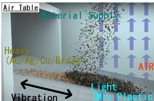
図 1 1 WEEE 事業導入技術（リサイクル設備）
