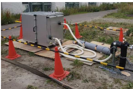
図 4.3.1-5 周期加熱法による熱応答試験・発熱ワイヤー付光ファイバー温度計
