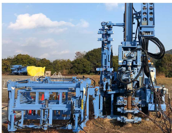
ロッドチェンジャーおよびロッドストッカー(左)、 地中熱交換器挿入機を用いた地中熱交換器挿入の様子(右)
