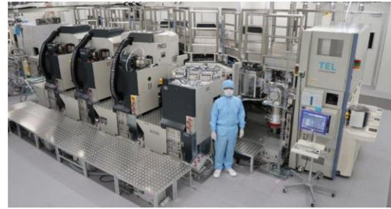
300mmウェハを100K以下に冷却してMTJ多層膜を積層するスパッタ成膜装置
