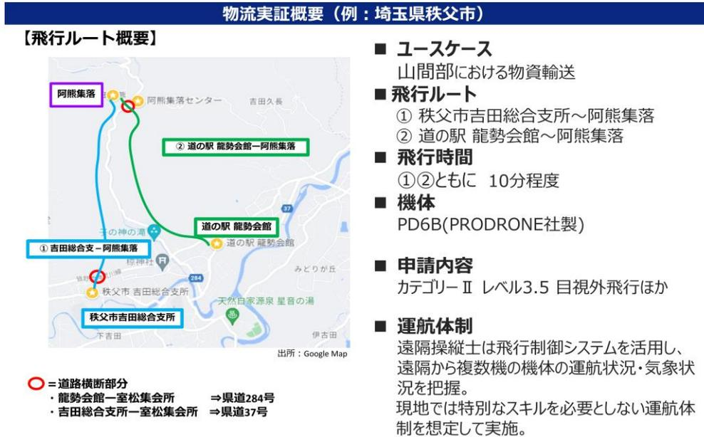
図1. カテゴリーII レベル3.5飛行での物流実証概要
