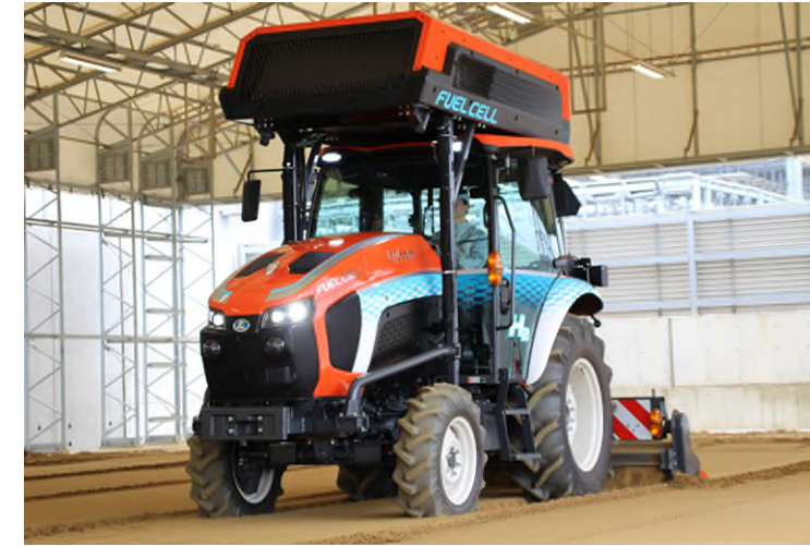
社内試験ほ場でのロータリ作業評価
