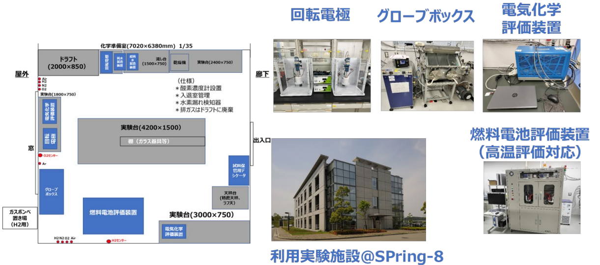
図2：プロジェクト専用化学実験室（入退室管理）； 試料前処理、燃料電池セルの調整、試料保管 等に活用
