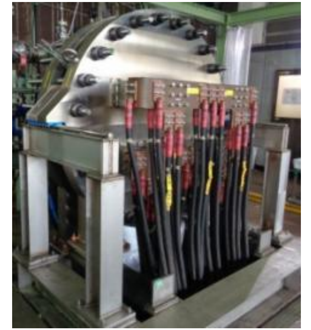
高圧型AWEパイロット装置 (トクヤマ)
