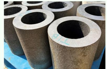
アンモニア分解プロセス特化型分解管試作製造サンプルの写真
