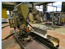
各種溶接法の施工性検証
