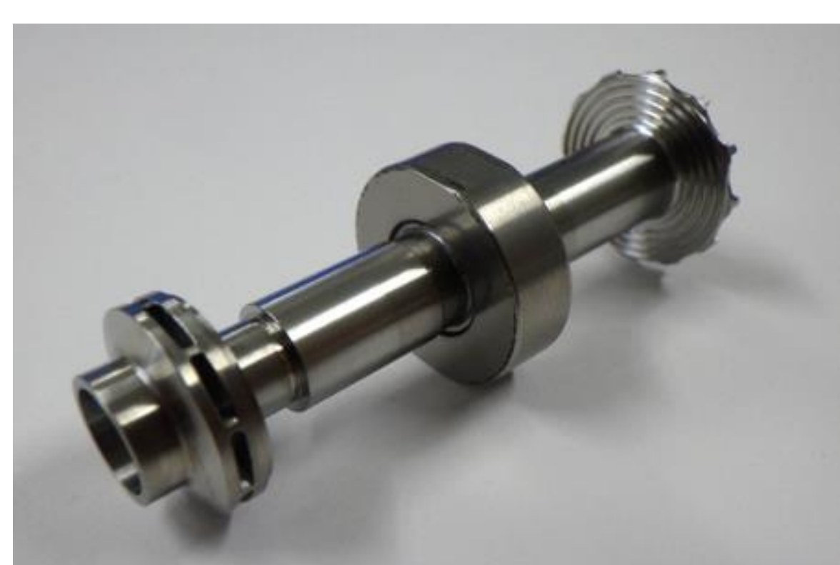
試作水素タービン インペー径：φ18mm 全長：66mm
