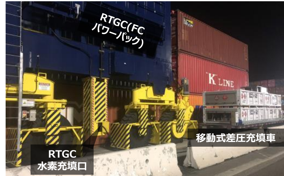
移動式差圧充填車による充填作業
