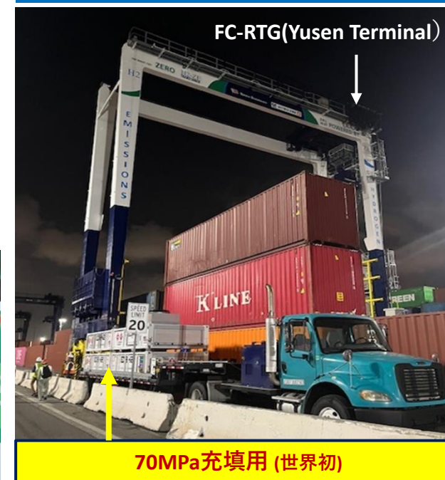
移動式差圧水素充填車(RTG)
