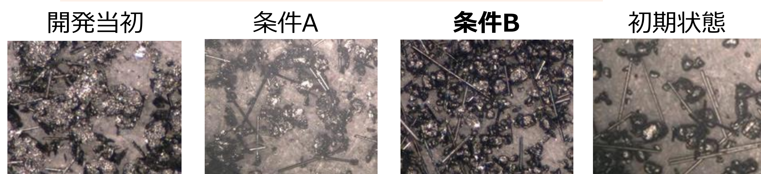
Fig.11_溶融混練後のカーボン状態
