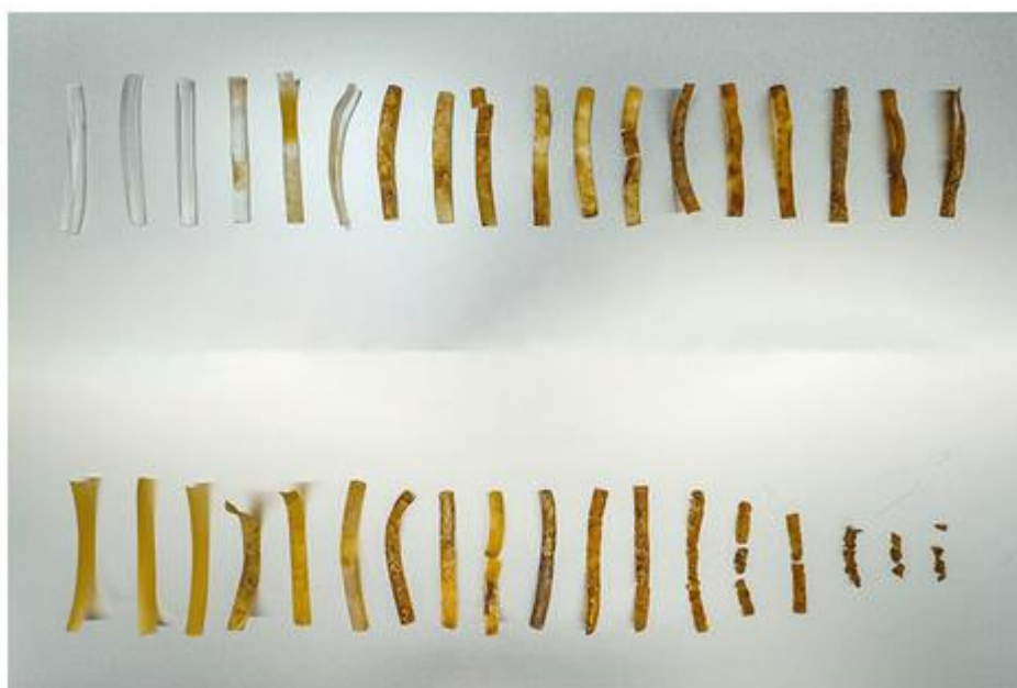
コンポスト中で5カ月間の分解段階を経た、普通の TPU 片 (上) と「生きている」TPU 片 (下)。
