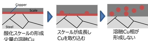
図1. 鋼材加熱段階での酸化挙動とCuの存在状態の変化
