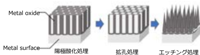
金属ナノ構造作製プロセス
