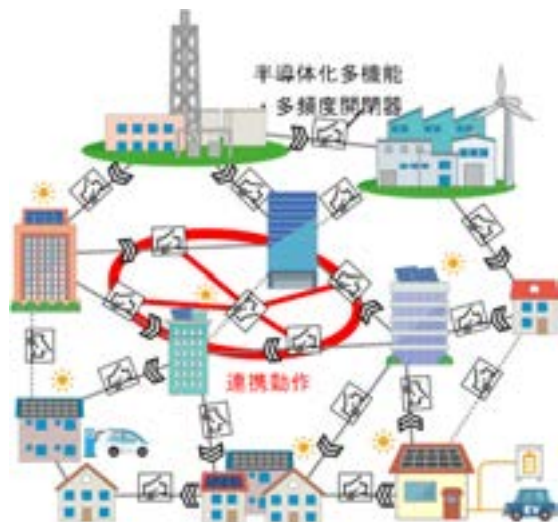
図1 電力輸送にボトルネックのない網目状送配電システム
