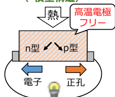
ゴニオ極性材料を用いた 新型熱電モジュール (横型構造)
