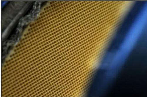
還元装置の内部。接触面積を増やし反応効率を上げるため網目構造になっている。網目構造の表面でNO<sub>x</sub>が除去される。
