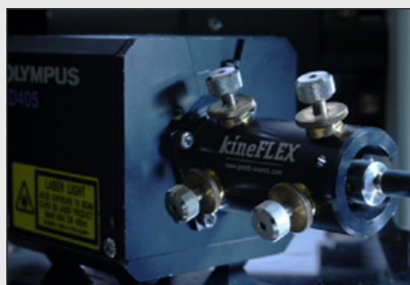
10cm弱の箱型にまで小型化されたレーザ発振器
