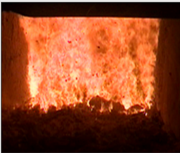
(左) 従来の炉内条件での燃焼の様子。火柱が高く立っている。 (右) ハイパー21ストーカシステムの炉内。両脇から高温空気が出ているため、火柱が“ふた”をされて燃焼スペースがコンパクトになり、低空気比でも燃焼が安定。 (画像提供：JFEエンジニアリング)
