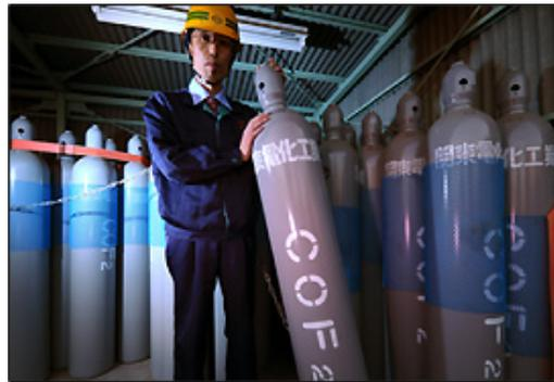
関東電化工業の製造したフッ化カルボニル(COF<sub>2</sub>)のボンベ
