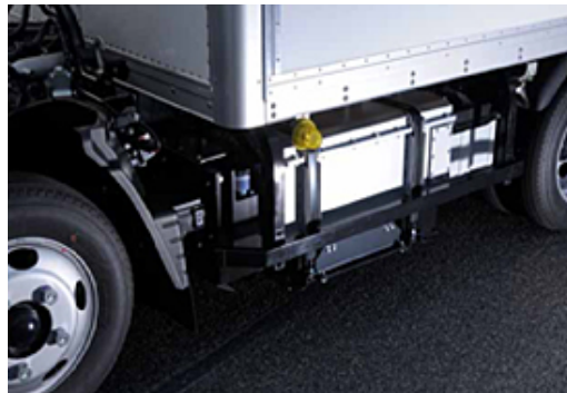
箱状の容器に収められたキャンターエコハイブリッドのリチウムイオン電池
