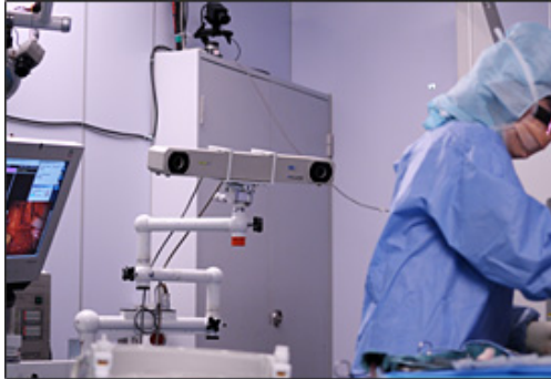
手術器具のマーカーを捕捉するカメラ（左）、手術器具につけられた十字状のマーカー（右）
