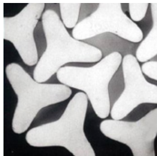
繊維断面の顕微鏡写真（極細、中空、異形など）
