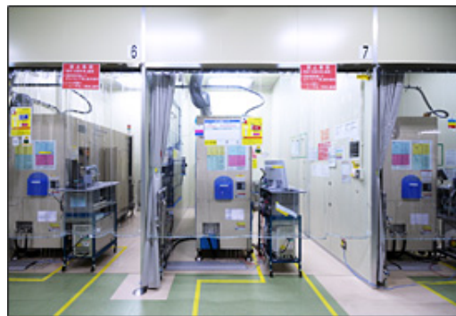
ギガフォトンの生産ライン。 仕切り間に置かれた箱状の機械が、 レーザー光源発生装置
