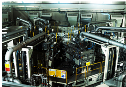
長崎県諫早市の長崎造船所内にあるアモルファスシリコン太陽電池製造用のプラズマCVD装置。星形なのは、直列でラインを長くしないためと、ラインの1工程がストップしても影響を最小限にするため
