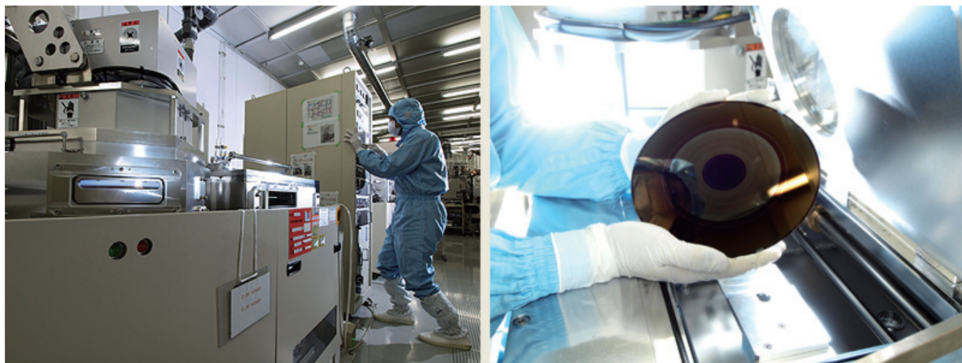
ドライエッチング装置（左）とエッチングの終わったウエハ
