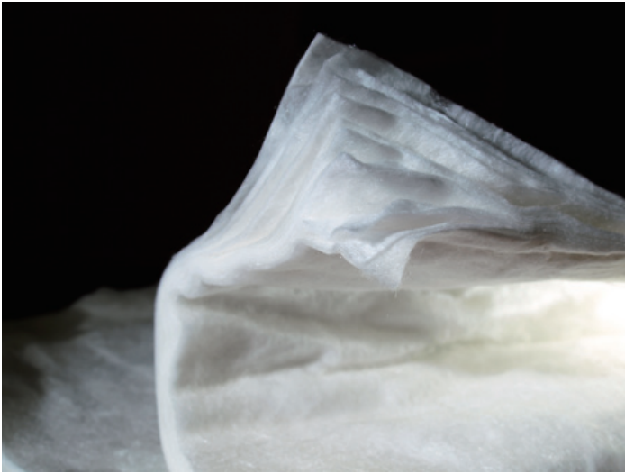
「U-Vacua」の芯材はパイ生地のような 多層構造のグラスウール
