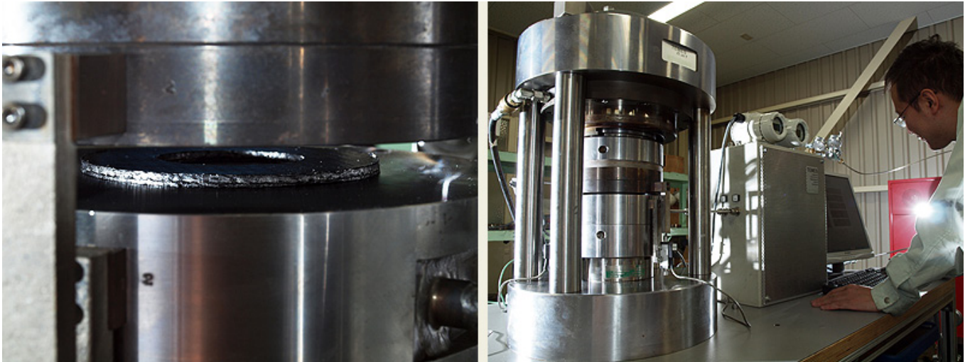
工場内のラボで行われている製品の加圧試験
