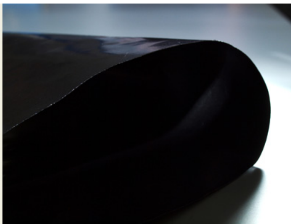
粉末の膨張黒鉛と、シート状になったガスケットの原材料
