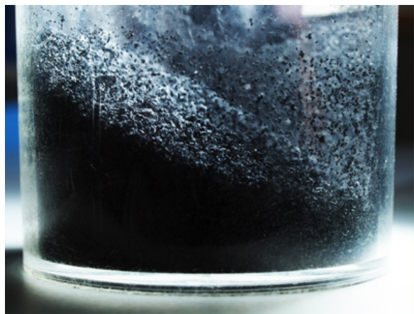
粉末の膨張黒鉛と、シート状になったガスケットの原材料
