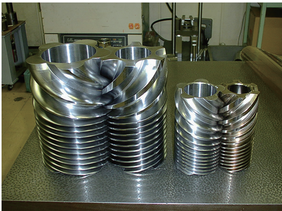
複雑な形状をした排気ポンプのスクリー。加工時間の大幅な短縮で、東京エレクトロンの半導体製造装置への実装にも目処が立ったと、大見教授は言う
