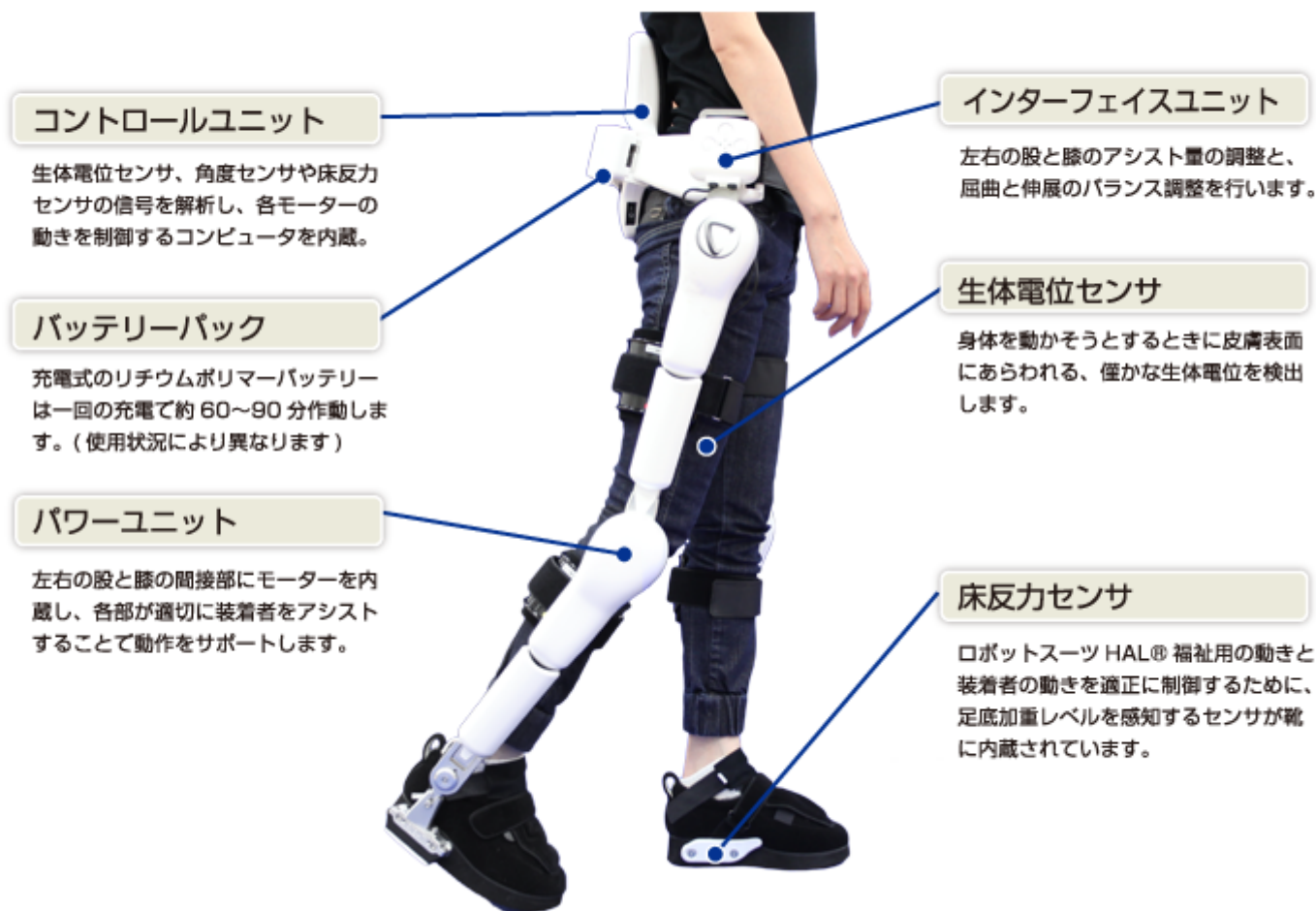
図1 ロボットスーツ HAL® 福祉用の装着例と各部名称。脚力が低下した人や、病気・怪我などで下肢の運動機能に障がいがある人が身につける第2の骨格のようなロボット。両脚モデル（写真）で11kg、単脚モデルは6kg。本体が床面に設置して重量を支える構造になっているため、身に着けた人が重みを感じることはない
