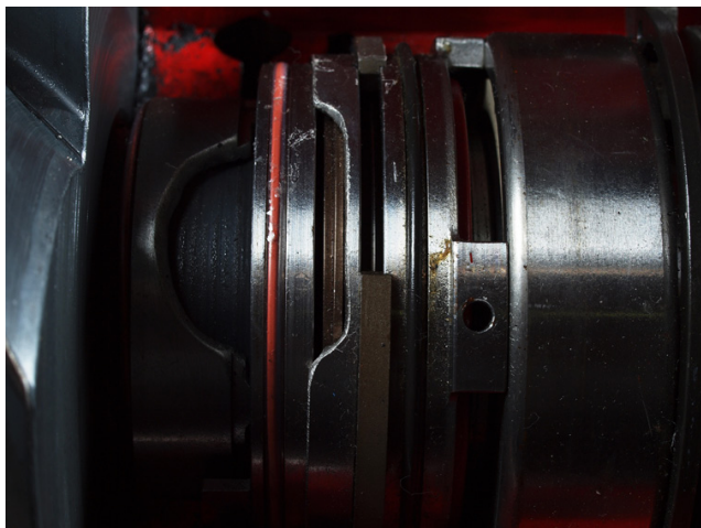
蒸気の漏れを最小限に食い止めるための軸シール部（旧モデル）
