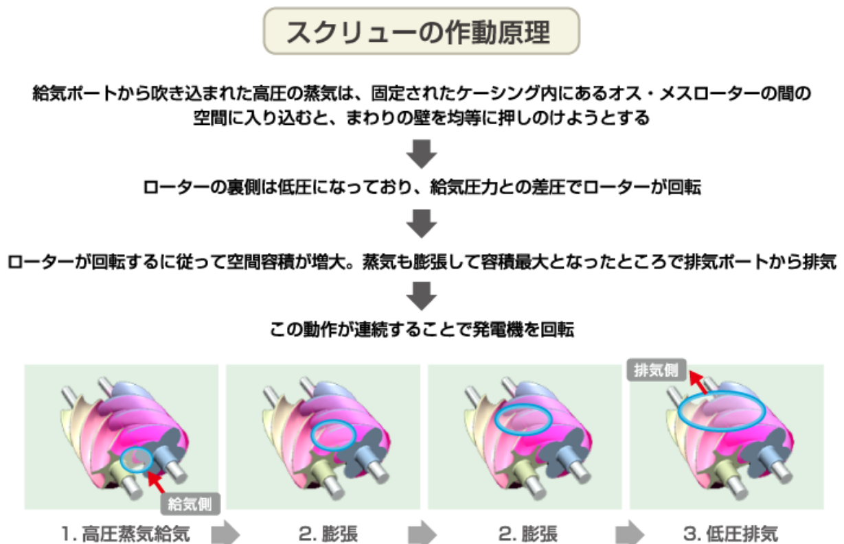
図6 スクリューが回転する仕組み
