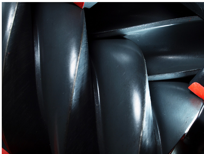
オスローターとメスローターの非接触の隙間はミクロン単位で加工
