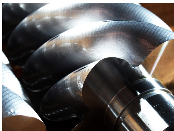
高精度加工直後のスクリュー表面
