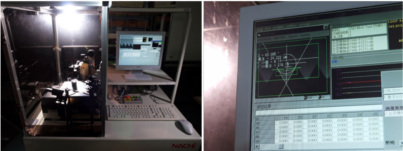
画像処理装置（左）とそのモニタ画面（右）。 CCDカメラつき顕微鏡での撮影結果が、コンピュータにより評価され、モニタに映し出される
