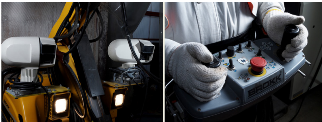
除去ロボットの目となるカメラ（左）、 アスベストが飛散する作業現場に入ること無く除去作業を可能にする遠隔操作装置
