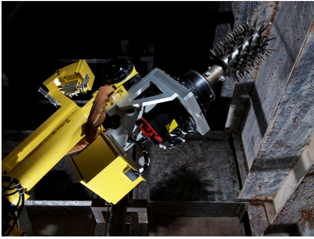
エレベーターシャフト用のアスベスト除去ロボットの腕部分。各関節部のセンサーが状況に応じた自動作業を可能にする
