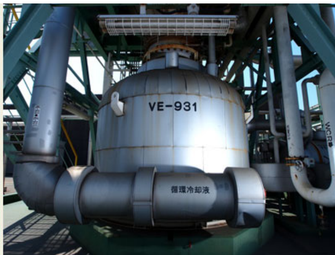
図3 冷却缶での液中燃焼法。一気に急冷することでダイオキシン類の再合成もない
