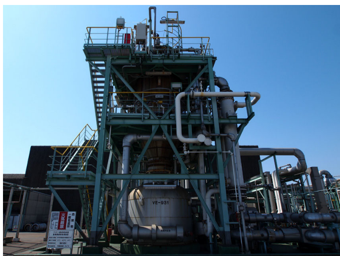
旭硝子千葉工場内に設置された 月島環境エンジニアリング製の「フロン類破壊装置」
