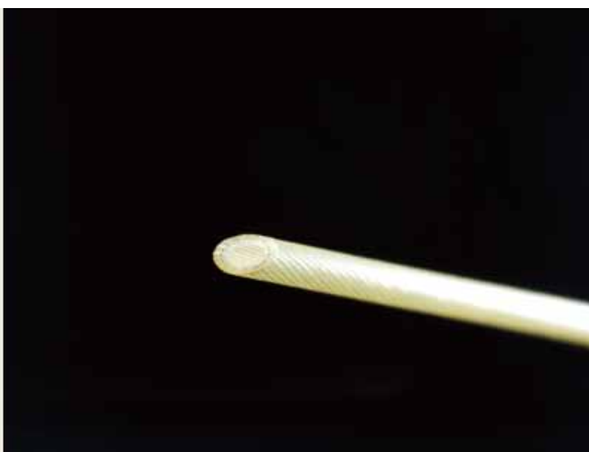
衝撃吸収ナイロンを使用したテニスラケット用ストリング（左）。その断面（右）。灰色の円形部分が衝撃吸収ナイロン
