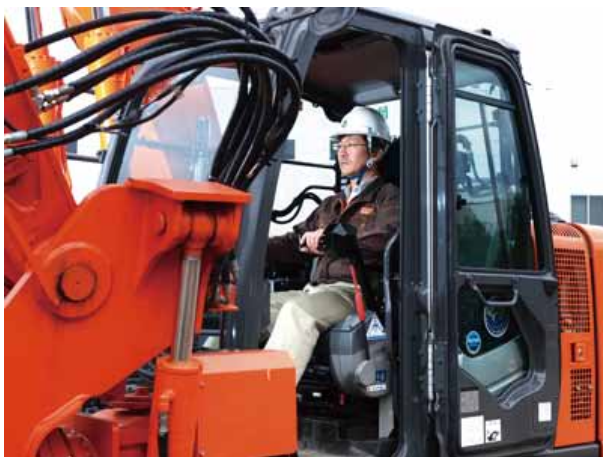
油圧装置の配置換えで運転席のヘッドクリアランスも大きくなり（左）、低床で乗り降りもしやすくなった ASTACO NEO（右）
