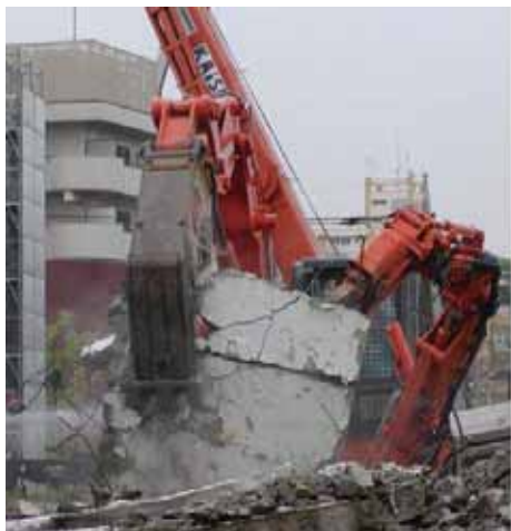
図4 一方の腕で支えながら、もう一方の腕で粉碎や引き出しなどを行う双腕機では、左右の腕の負荷が大きく異なる（写真は試作機のもの）
