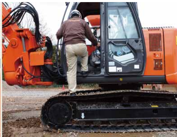
油圧装置の配置換えで運転席のヘッドクリアランスも大きくなり（左）、低床で乗り降りもしやすくなった ASTACO NEO（右）
