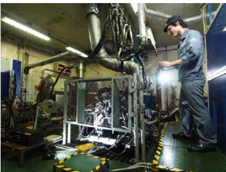
さらなるクリーン化を目指して改良実験中のSKYACTIV-D
