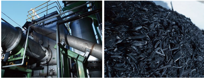
炭化物フィーダ（斜め状のパイプ）と熱風発生炉（左）、 熱源として使用された炭化物（右）
