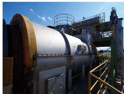
横手市のプラントで実際に稼働している ロータリーキルン方式のガス化炉
