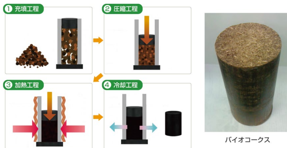
図7 バイオコークスとその製造法 (資料提供：一般財団法人石炭エネルギーセンター)
