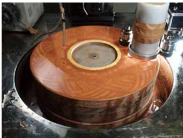
上部の管状の部分から砥粒が送り込まれ、 上下のパッドでガラス工作物の両面を同時に削る。 エポキシパッドを装着した研磨装置
