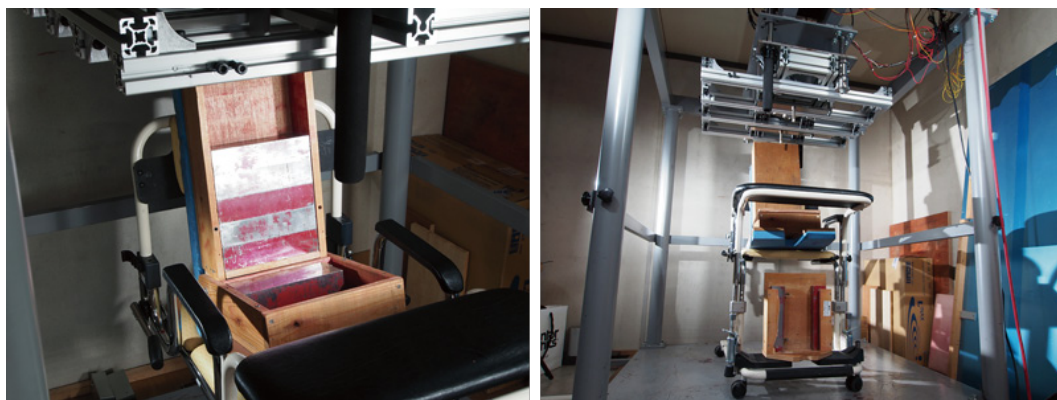
鉄製のおもりを移乗器に載せて強度や耐久性をチェックする落下試験装置。 現在では様々な製品の耐久試験に使われている
