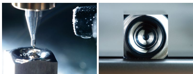
超硬度合金のスミダイヤバインダレスによる切削、研磨（左）、美しく鏡面に仕上がった工作物（右）
