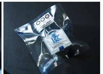
CLBOのパッケージング装置(左)と梱包状態のCLBO素子(右)。 大変デリケートな結晶であるため、 外気に触れずに梱包して出荷する
