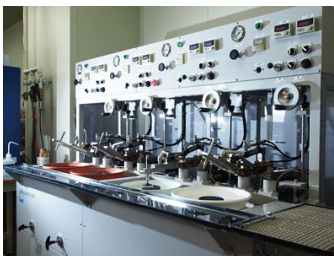
無水面研磨装置(左)、面研磨装置(右)。 超低湿度環境で、水を使わずに研磨する
