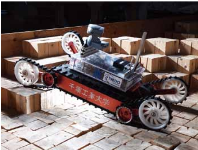
低重心化によりがれきでの優れた走破性能を実現した「Kenaf」
