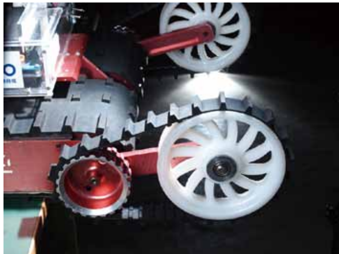
先端部分を大きくした「Kenaf」のサブクローラ
