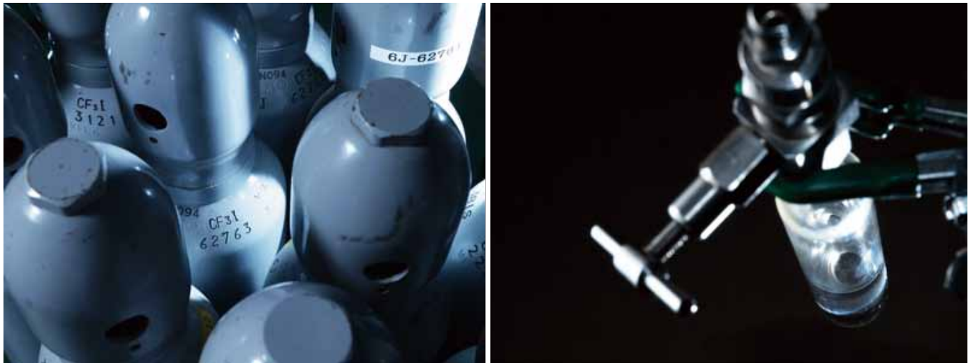
東ソー・エフテックが製造しているヨウ化トリフルオロメタン（CF 3 I）。ボンベ（左）、耐圧容器内では無色透明の液体状態（右）
