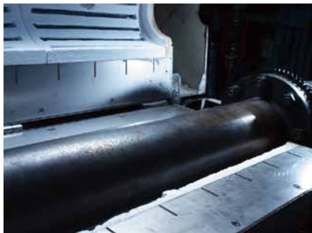
度重なる試行錯誤の末、CF 3 I の合成、 量産化を可能にしたロータリーキルン
