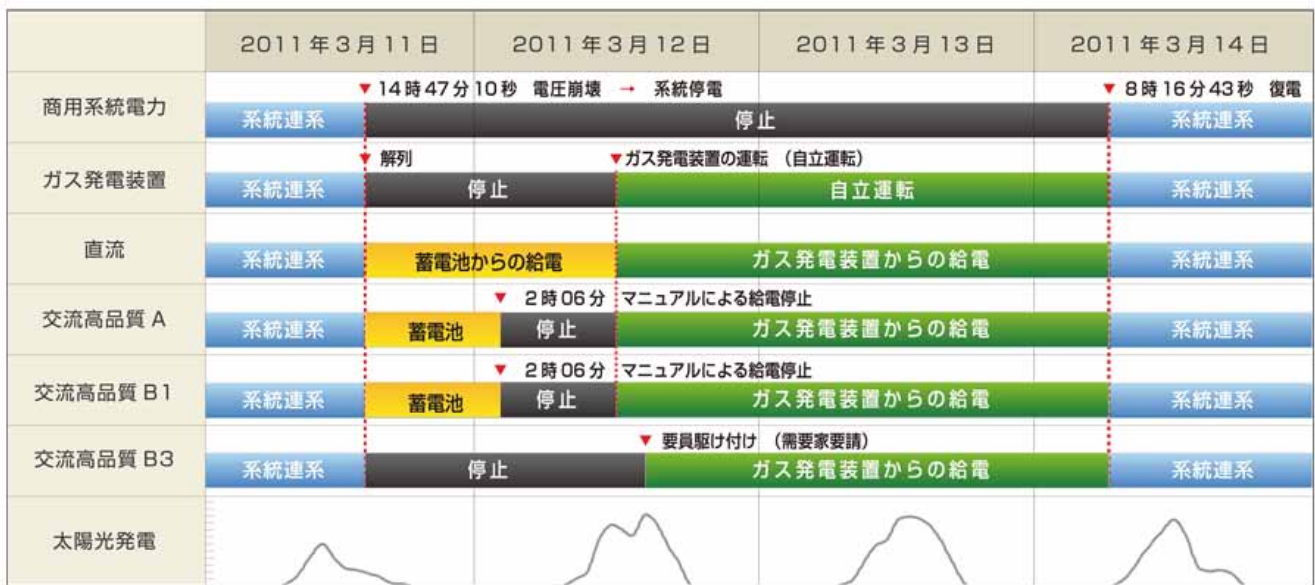
図9 震災発生後、商用電力停電中も給電を続けた実証プラントの稼働状況
