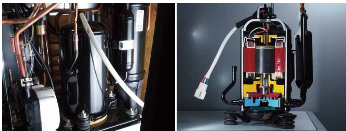
デンソーのエコキュートに装備されている圧縮機（左）とそのカットモデル（右）
