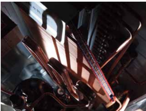
NEDO プロジェクトで開発した要素技術（大能力圧縮機、2段アルミ製熱交換器、オフセットフィン熱交換器等）を組み込んだ分離型エコキュートのカットモデル
