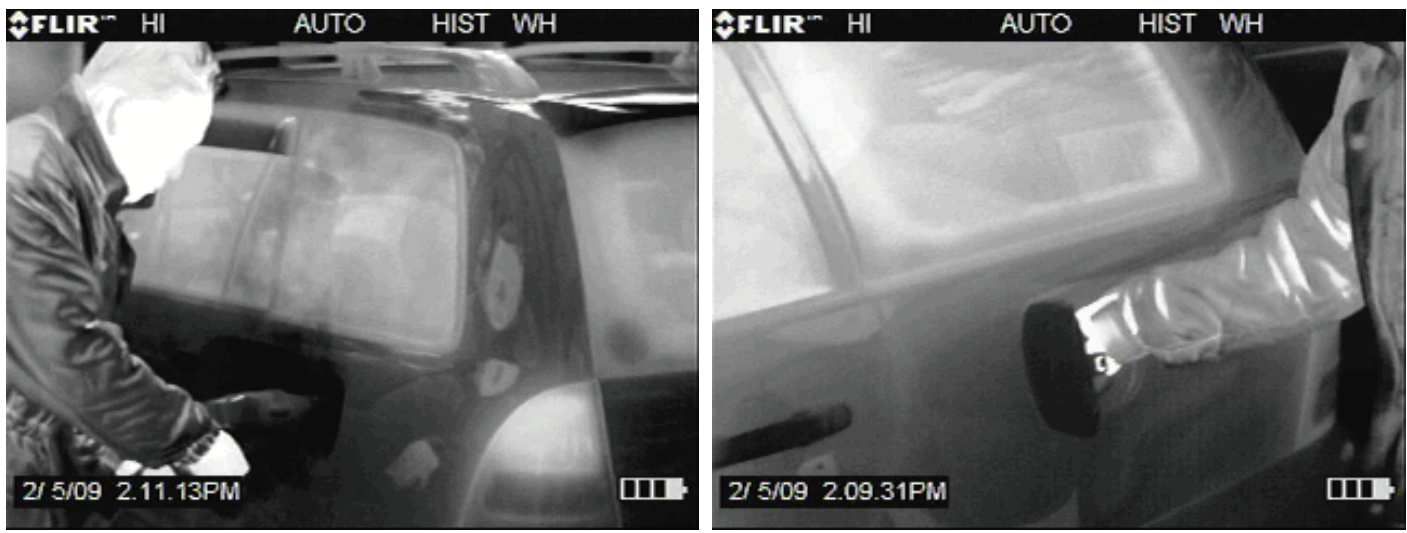
特殊カメラで撮影したガソリンベーパー発生の様子。 給油口から立ち上がる黒い霧がガソリンベーパー（画像提供・株式会社タツノ）
