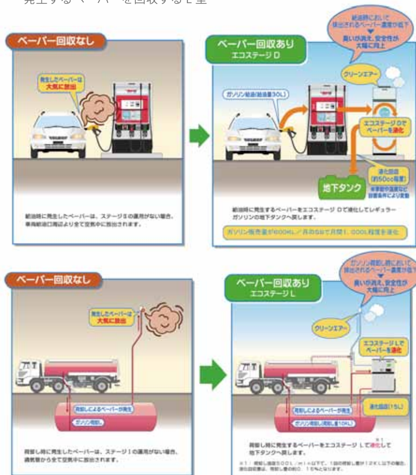
図3 エコステージD型（上）とL型（下）の導入効果イメージ。給油時、荷卸し時のベーパー発生量は多く、本機を設置することでVOCの排出抑制と資源の活用（損失削減）、臭いのないクリーンなスタンド環境の実現、安全性の向上も期待できる
