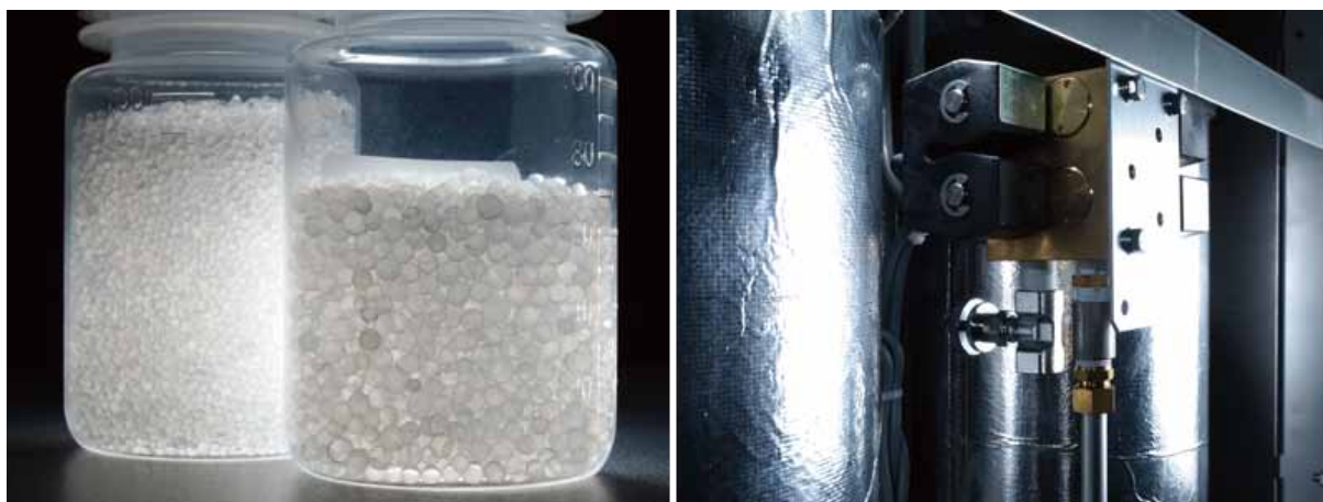
「エコステージ」の高濃度化システム（左写真が吸着剤、右写真が吸着塔）。
